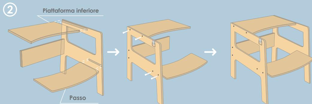
2. Quindi avvitare la piattaforma inferiore e passo sul supporto inferiore, successivamente fissa il secondo supporto inferiore e avvitalo.
